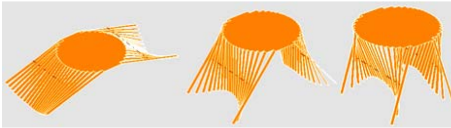
图 19 桌面不同高度下的桌腿形状变化示意图
